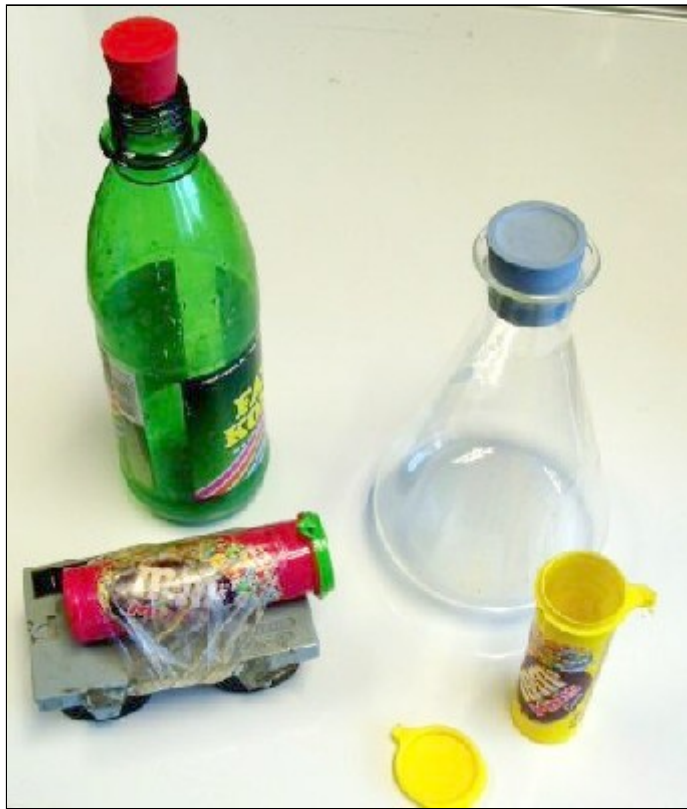
Forskellige beholdere, der kan anvendes som kanon. Blandt andet et plastikrør, der er placeret på en lille bil, så man kan studere rekyl.
